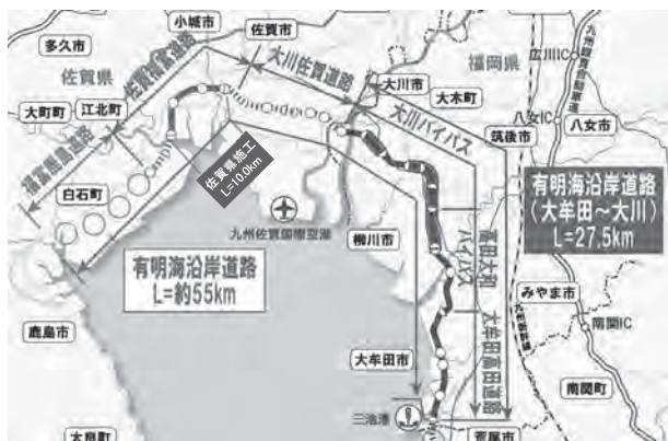
図－1 有明海沿岸道路の概要
