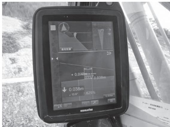
図-4 バックホウキャビン内モニター
