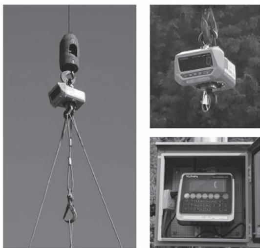
図-6 吊荷計量装置(クレーンスケール)
