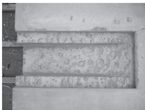
図-3 模擬試験体下面の気泡滞留状況
