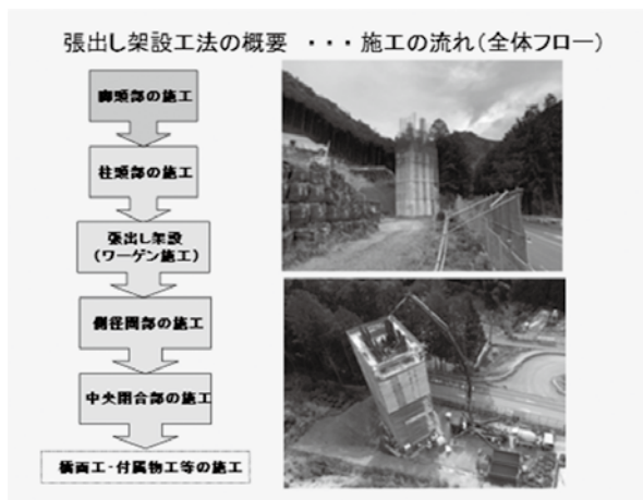
脚頭部の施工
