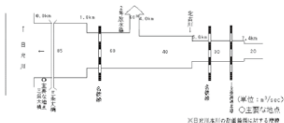
図. 2 野府川河川整備計画の流量配分図
