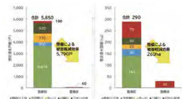
図. 5 日光川2号放水路整備による被害軽減効果 （年超過確率1/5：24時間雨量164mm）
