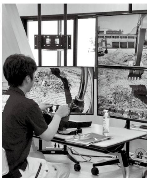
建設機械の遠隔操作
