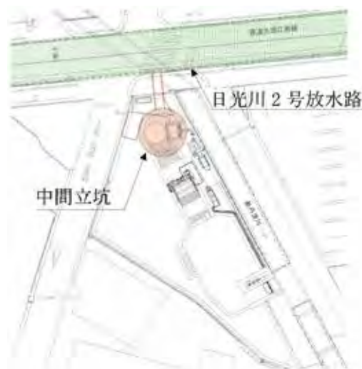
図. 9 中間立坑の計画平面図
