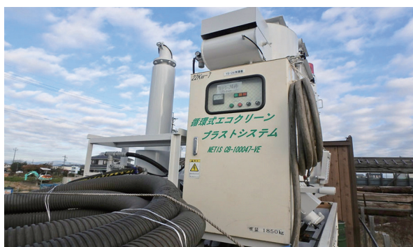
写真-11 循環式エコクリーンプラストシステム
