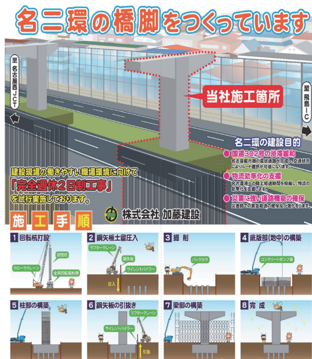
図-2 施工手順図
