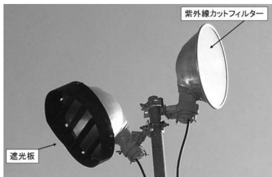
写真-4 遮光板や紫外線カットフィルターを取り付けた坑外照明
