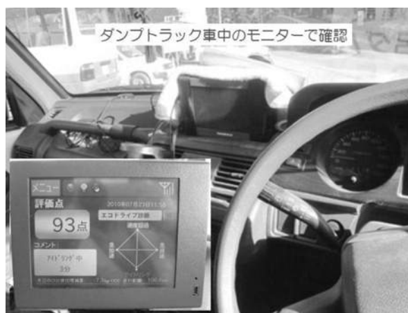
写真-2 車両運行管理システム (ECO-DAS)
