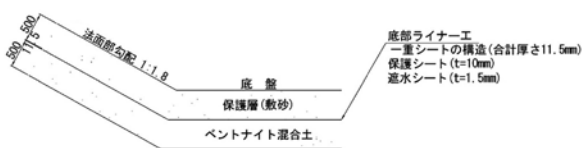
図-3. 底部ライナー工 構造図
